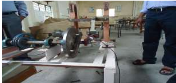
Figure 4.10. Flexural fatigue test rig.
