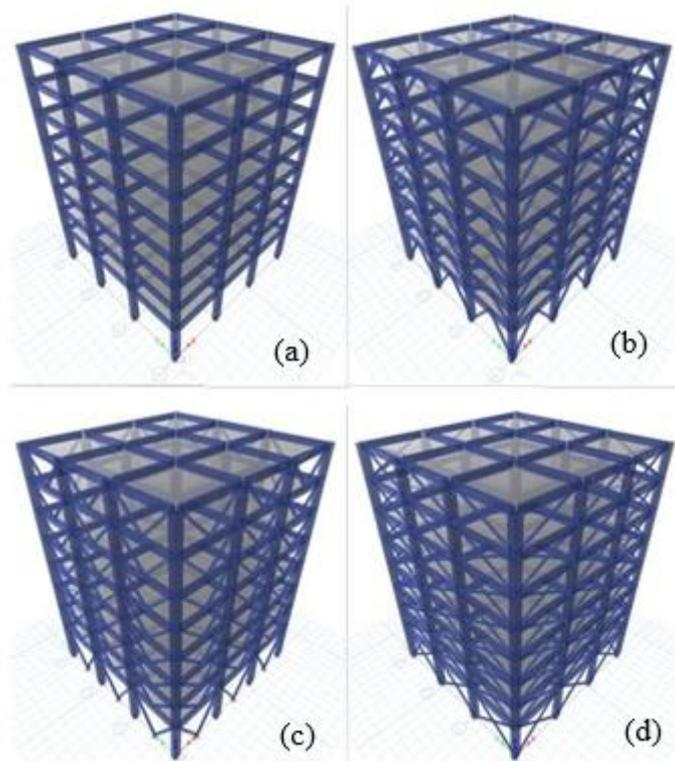
**Figure 1** 3D view of 8 storey (a) MR (b) IVB (c) VB (d) XB frames
